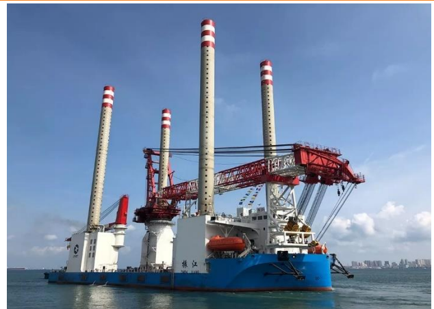
图 36：国内首座 1200 吨自航自升式风电安装平台“振江号”
