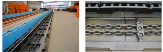
图58: 矿用圆环链是刮板输送机的关键部件
