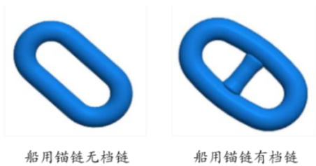
图22: 若尺寸和材质相同，有档链强度较无档链大
