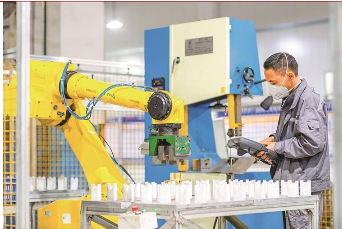
图34: 箭牌家居三水基地的铸件切割高效自动化机器人产线
