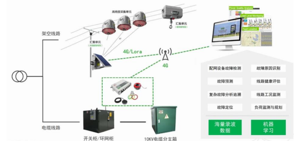
图24：智能配电网线路状态监测系统（IWOS）
