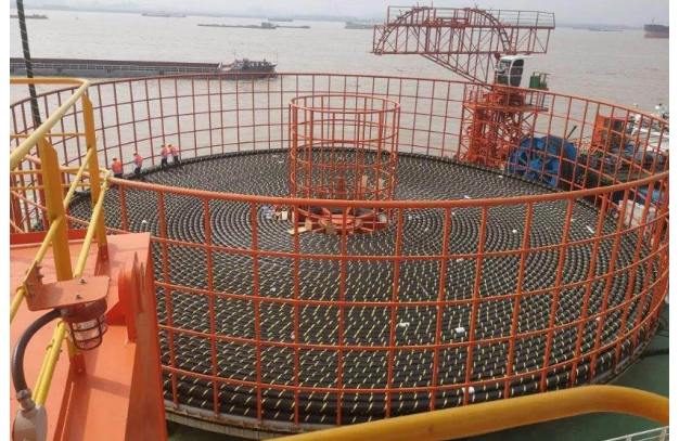
图 27. 敷缆船配置的储缆盘
