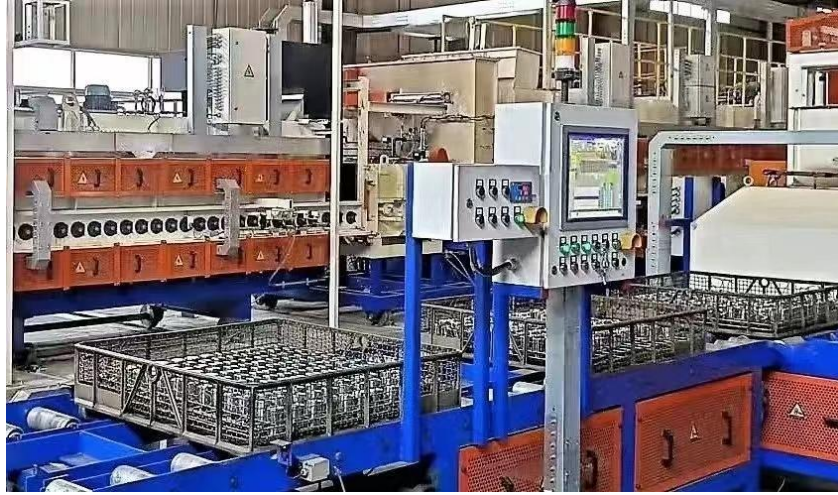
图 29：公司盐浴热处理自动流水线
