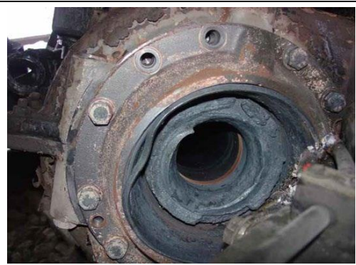
图 33：列车轴箱轴承故障案例图（二）
