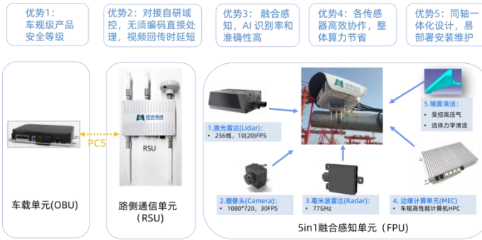
图40： 公司 V2X 车路协同系统组成
